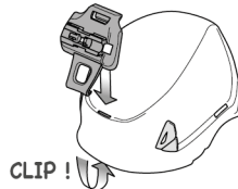
Rear helmet clip / Platine arrière
