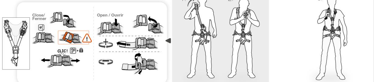
Installing the TOP CROLL on the harness ventral connection point / Installation du TOP CROLL sur le point ventral de liaison du harnais cuissard
