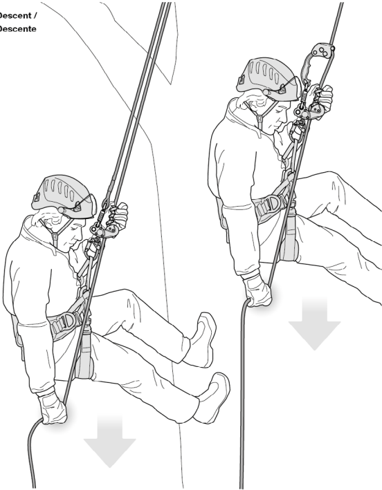
Positioning at the work station / Maintien au poste de travail
